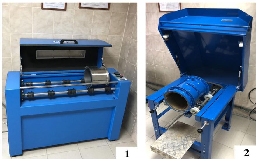
*Рис. 1. Испытательное оборудование при контроле износостойкости заполнителей асфальтобетонных смесей: 1 – установка Микро-Деваль, 2 – установка Нордик-Тест (иллюстрация авторов)*
