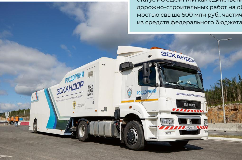
◀ Передвижная лаборатория «Эскандор» создана для решения задач дорожного нацпроекта. В мире существует только 20 лабораторий подобного типа. «Эскандор» может измерять параметры просадки асфальта прямо на ходу со скоростью до 70 км/ч. В день техника может оценить до 400 км дорог. Ранее с помощью данной передвижной лаборатории было продиагностировано более 3 тыс. км дорожного покрытия в пяти пилотных регионах: Мурманской, Курской, Ростовской и Оренбургской областях, а также в Республике Татарстан
