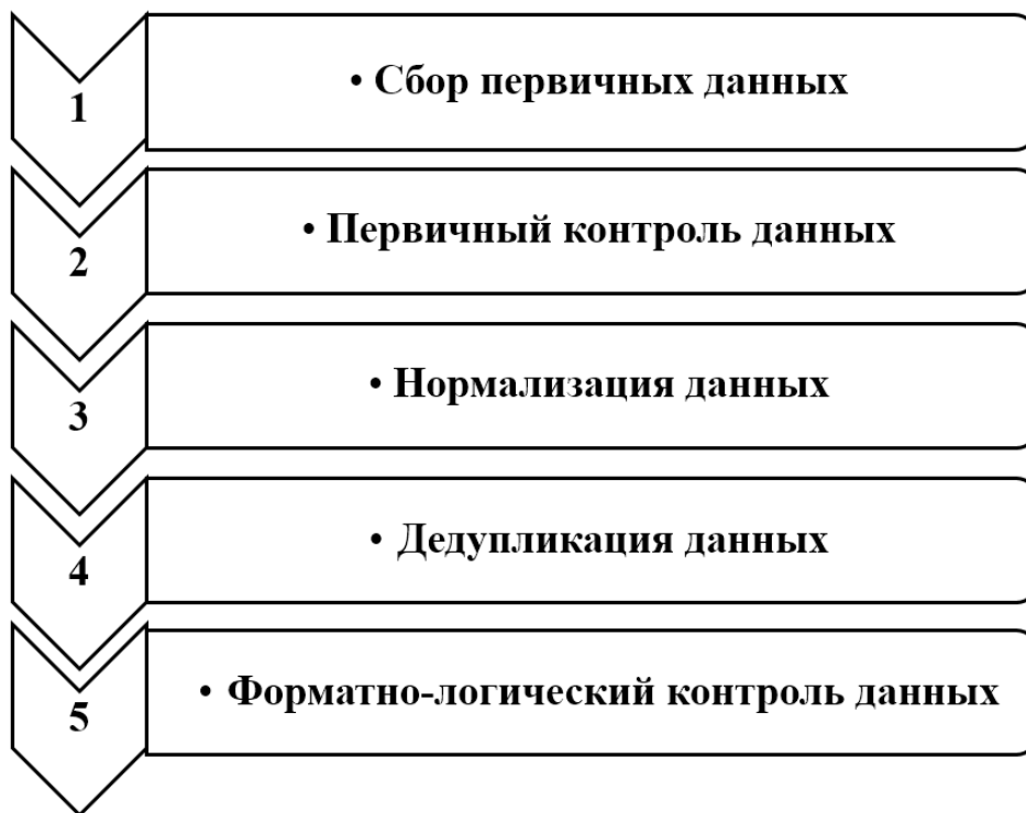
Рис. 2. Этапы обработки данных мониторинга элементов ИТС
