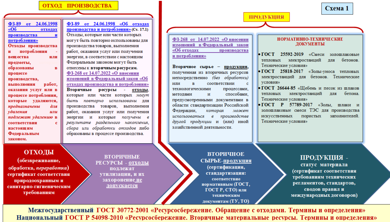
Рис. 7. Общая схема перехода от отхода производства к продукции
