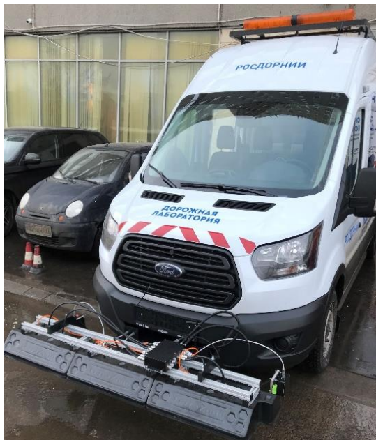
Система георадиолокационного оборудования НПО «Терразонд» из трех блоков «ГРТ-22» с линейным изменением частот от 500 до 2000 МГц
