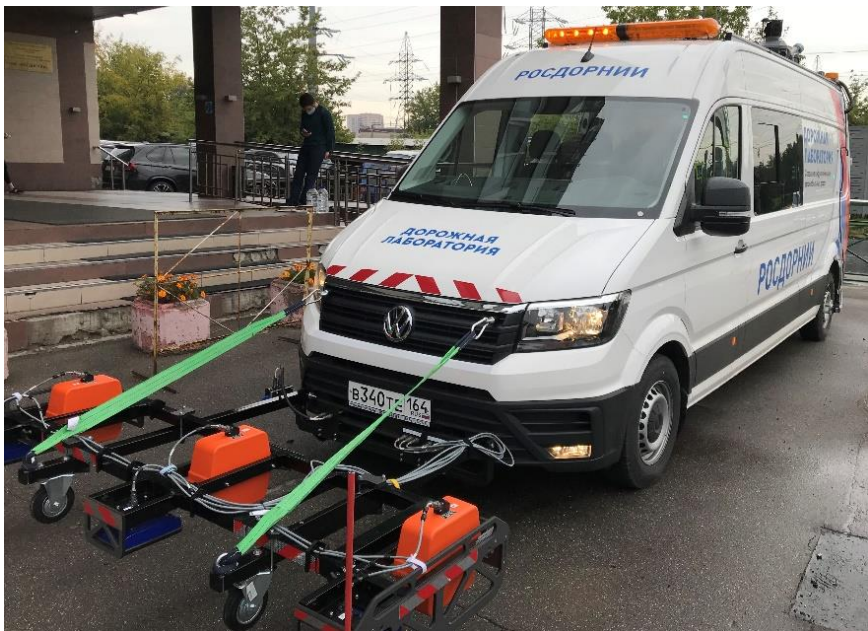
Система георадиолокационного оборудования на базе импульсного георадара «ОКО-3» с двумя линейками антенных блоков с частотами 700 и 2000 МГц
