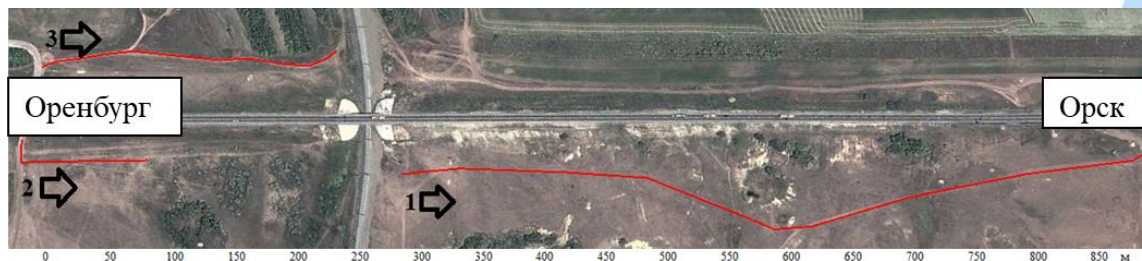
Метки: 1 и 2 – Деформационный шов, от 3 до 9 – просадка на проезжей части
