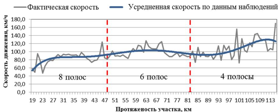
*Рис. 4. График скорости транспортного потока М9 «Балтия», построенный по данным, полученным при помощи секундомера (участок 19+000 – 114+560 км; Волоколамск – Москва)*
