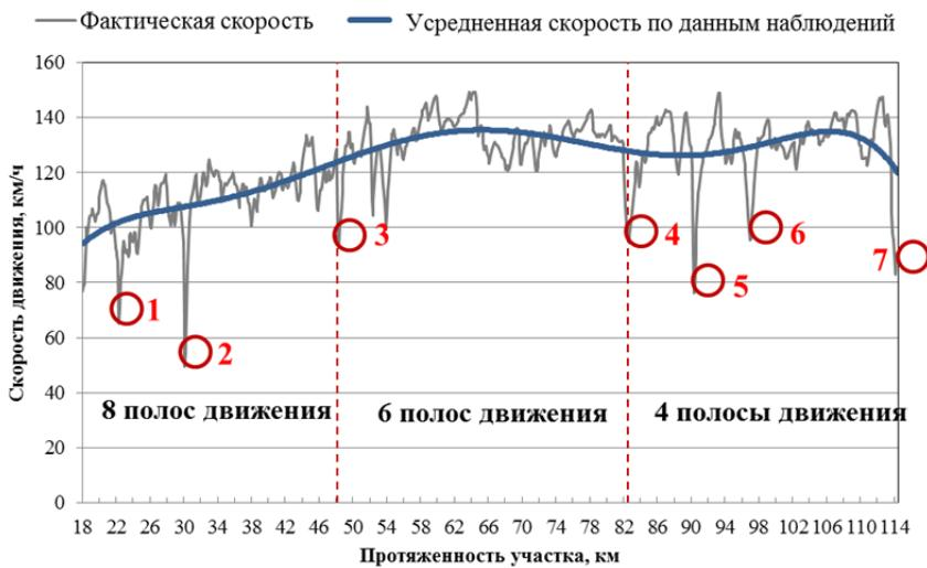
*Рис. 2. График скорости движения автомобиля-лидера на автомагистрали М9 «Балтия»
