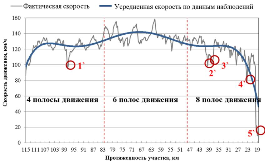
*Рис. 3. График скорости движения автомобиля-лидера на автомагистрали М9 «Балтия»
