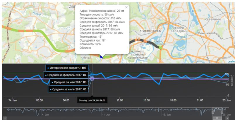
*Рис. 6. Пример выходных данных о скоростях движения на автомагистрали М9 «Балтия», полученных с использованием ГЛОНАСС/GPS*
