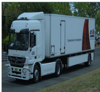
Рис. 10. Георадар и установка движущегося дефлектометра для комплексного обследования автомобильных дорог
