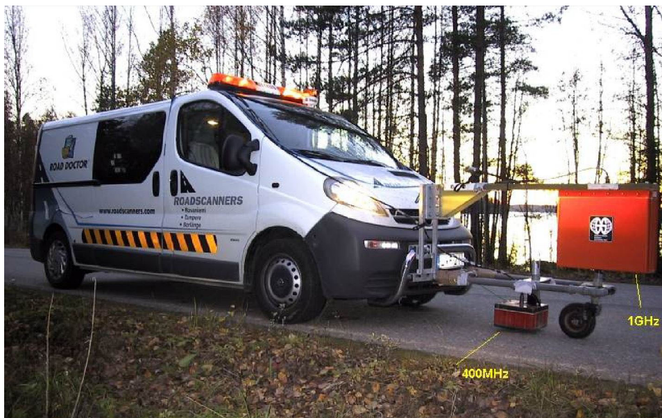
Рис. 1. Передвижная дорожная лаборатория с антеннами георадара 1,0 ГГц и 400 МГц
