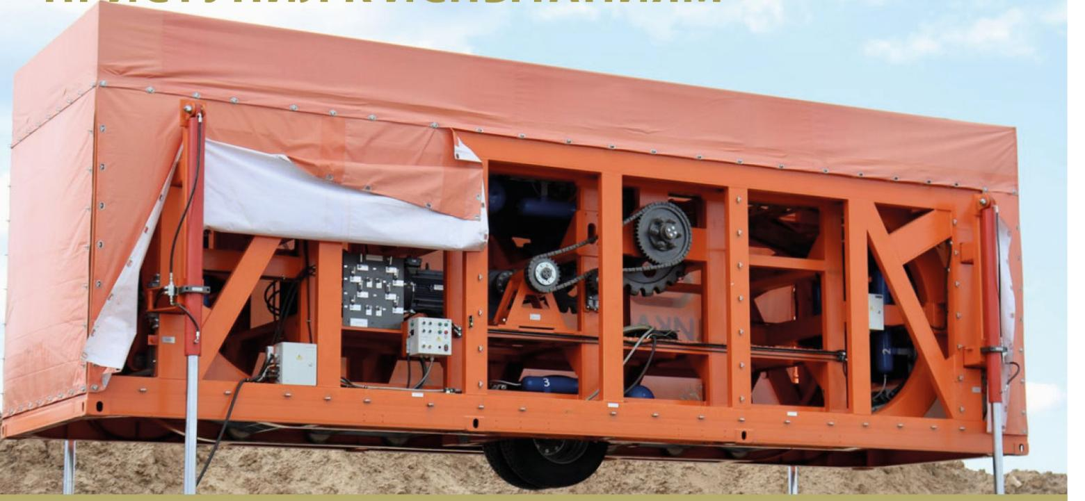
27 июля РОСДОРНИИ при участии ГК «Автодор», ООО «Автодор-Инжиниринг» и строительно-инвестиционного холдинга «Автобан» запустил сравнительные испытания двух типов конструкций дорожных одежд с использованием первого в России симулятора колесной нагрузки «ЦИКЛОС» (СКН «ЦИКЛОС») в Нижегородской области на специально построенном испытательном участке четвертого этапа строительства скоростной автомобильной дороги М-12 «Москва – Нижний Новгород – Казань», на ПК 2619+00.
