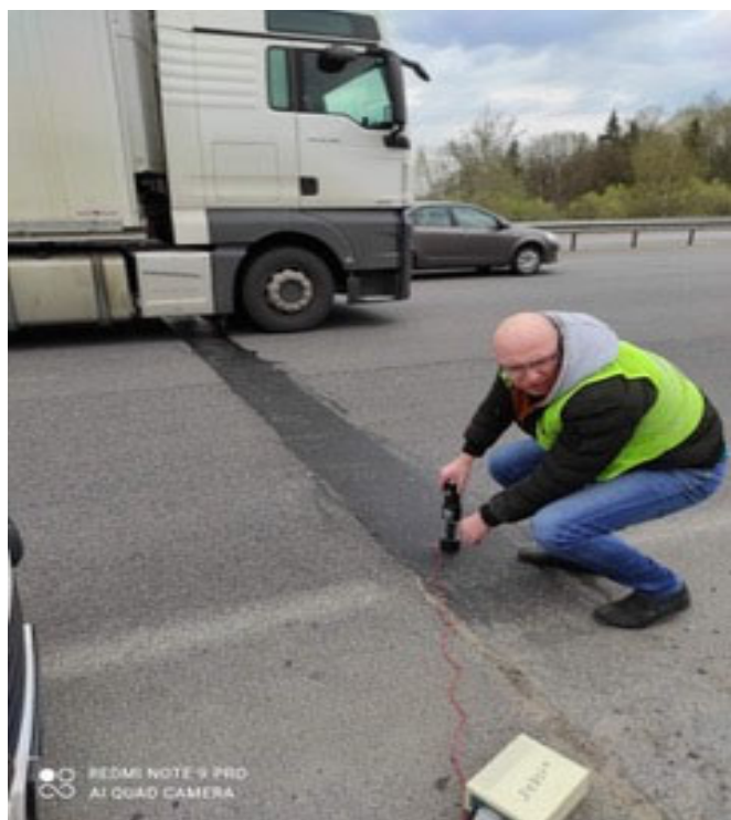
Рис. 5. Исследование с помощью прибора ИПМ-1 деформационных характеристик материала заполнения шва
