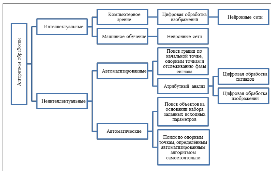
Рисунок 14. Алгоритмы обработки и интерпретации георадиолокационных данных
