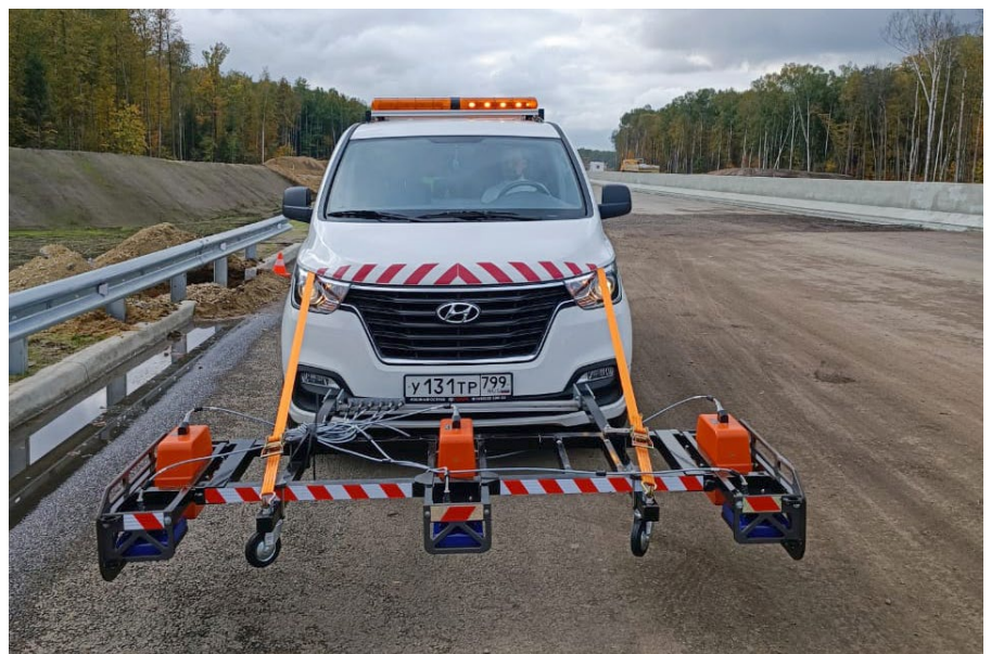
Рисунок 1. Шестиканальный георадиолокационный комплекс на базе передвижной дорожной лаборатории РОСДОРНИИ
