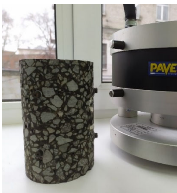
Рис. 8. Устройство для центрирования металлических цилиндров (слева) и образец с приклеенными металлическими цилиндрами (справа)
