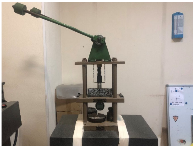
Рис. 1. Маятниковый прибор для определения модуля упругости асфальтобетона в соответствии с ВСН 46-83
