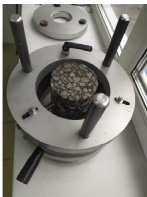
Рис. 8. Устройство для центрирования металлических цилиндров (слева) и образец с приклеенными металлическими цилиндрами (справа)
