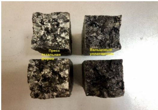
Рис. 3. Сравнение изломов балочек, уплотненных на прессе в стальной форме (по оригинальной методике) и уплотненных на вальцовом уплотнителе
