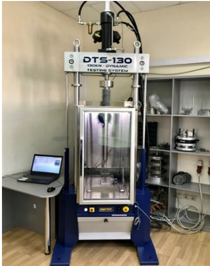
Рис. 2. Универсальная динамическая установка DTS 130 с испытательным устройством для определения модуля упругости асфальтобетона в соответствии с ВСН 46-83
