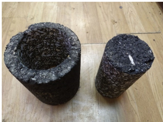
Рис. 7. Подготовка образцов для определения модуля упругости
