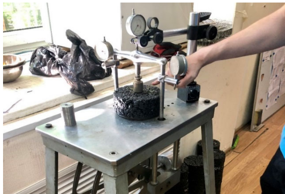
Рис. 6. Проведение испытания на определение модуля упругости на рычажном прессе в соответствии с ВСН 46-83
