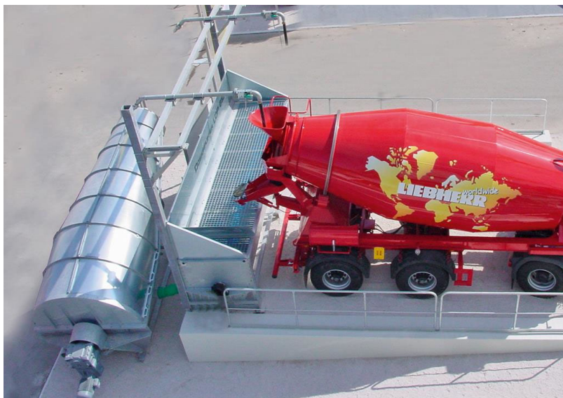
Рис. 3. Приемный лоток в установках компании LIEBHERR (Германия)
