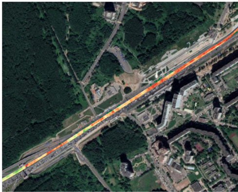
Рис. 8. ГИС-слои с результатами георадарного обследования: а) карта изменения толщины асфальтобетона (ГРТ-3); б) карта изменения амплитуды сигнала в диапазоне 10-15 нс (ГРТ-1)
