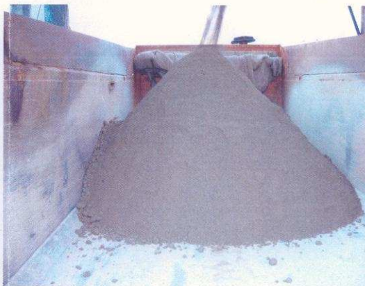
Готовая гидро-полимер-цементно-грунтовая смесь с характерной для нее осадкой
