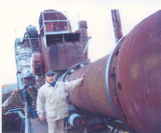
Приготовление ГПЦГ на гравитационном центробежном автоматическом перемешивающем агрегате (ГРАВИЦАПА-2007)
